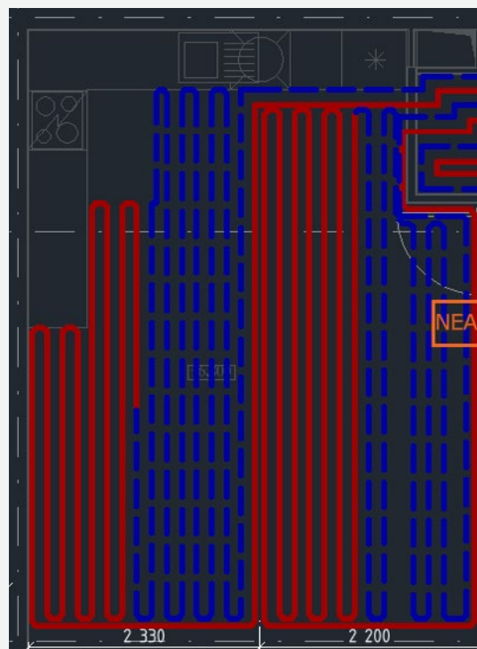
Foto: príklad umiestnenia a vynechania rozvodov vykurovania a chladenia v priestoroch kuchyne
